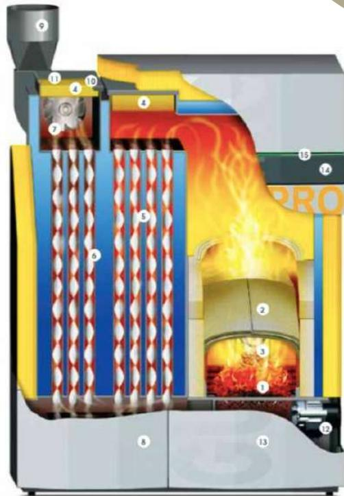
La chaudière PRO 175 ou 250 offre à ses utilisateurs un système de chauffage aux granulés de bois où au bois déchiqueté automatique, confortable et fiable.
